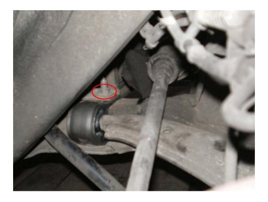
Cette vis maintient également le silentbloc arrière du triangle, cela ne m'a pas posé de problème, ce silentbloc est maintenu par une 2<sup>ème</sup> vis dédiée.
