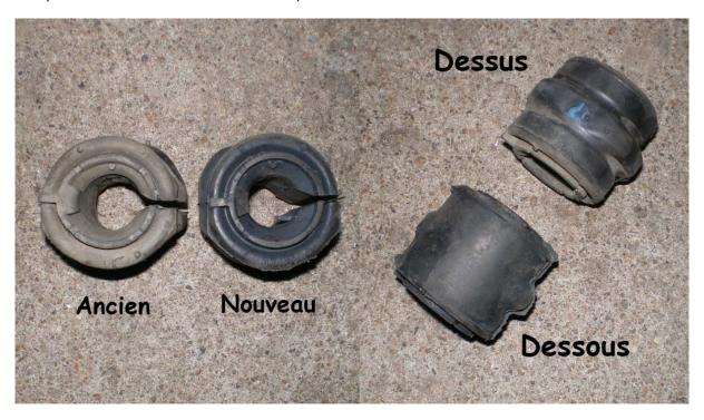
Sur la partie droite de l'image, on peut distinguer le dessus du dessous d'un palier grâce au bosselage qui se loge dan la bride, le dessous étant lisse.
